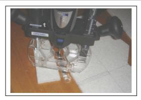
11.Le calibrage de la profondeur de coupe se fait ainsi, en mettant la pointe de la fraise sur une lame de cutter de bureau. Attention, l'épaisseur d'EPP peut être assez variable. Ce calibrage devra donc être refait pour chaque gouverne.
