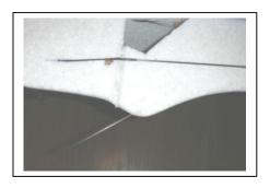
30. Mise en place du patin de queue en jonc carbone 15/10 planté de 15mm dans le bossage sous le stab.
