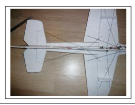
25. Montage de la triangulation arrière. Bien vérifier à ce moment là, le parfait alignement de l'aile et du stab.
