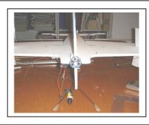
28. Vous mettez le train en croix en plantant les 2 extrémités des joncs dans les trous repérés à cet effet sur l'intrados de l'aile. La ligature en fil à coudre doit glisser dans le croisement à la traversée du fuselage. Vous déplacez les joncs jusqu'à ce que les ailes soient parfaitement horizontales. Une goutte de cyano dans les traversées d'aile pour tout immobiliser.
