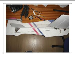
16. Montage des tringleries de direction et de profondeur en jonc carbone 15/10. Les articulations sont faites avec de la gaine thermo-rétractable de 2mm. Le montage des ailerons ne se fera que plus tard.
