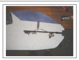
15.Installation de la radio : Contrairement à cette photo, il vaut mieux le faire après le montage des ailes et du stab. Les servos sont simplement collés par quelques points de UHU poor
