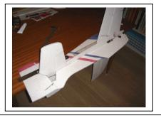
13. Collage des guignols de toutes les commandes de vol avec de la cyano sans accélérateur pour que la colle s'infiltre bien par capillarité. Le bout du guignol (future articulation) doit être à 8 mm de la surface de l'EPP. Les guignols d'ailerons doivent être décalés de 2 mm en arrière de l'axe gouverne pour tenir compte du différentiel induit par les tringleries inclinées.
