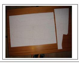
2.A partir de gabarits papier tirés du plan, tracé de tous les éléments dans de l'EPP 6mm. Un peu plus d'une feuille d'EPP 600 X 900 est nécessaire. N'oubliez pas pour le futur montage que le dessin de l'aile est l'intrados. C'est la raison du calage moteur vers la gauche.
