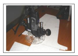
10. Les charnières sont réalisées directement en creusant l'EPP avec une défonceuse et une fraise conique. Pou éviter tout futur déchirement en cas de crash, rajoutez un petit morceau de blenderm de 10 X 20 mm aux extrémités des articulations (extrados).
