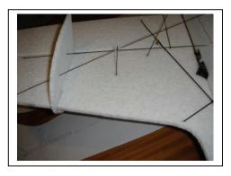
24. Des joncs anti-flambage (de l'aile en EPP) doivent être installés sur chaque aile. Ils sont composés de jonc 10/10 qui traverse l'aile et viennent se fixer verticalement à la croisée des haubans d'aile. La fixation se fait par une ligature en fil à coudre avec une goutte cyano
