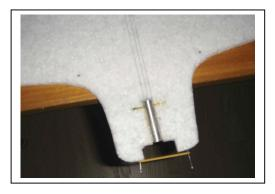
12.Collage du bâti moteur à l'epoxy sur l'aile.
