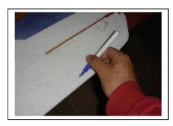
6. Les passage de haubans peuvent aussi être repérés sur l'autre face en plantant une aiguille. Un point au feutre peut ainsi être réalisé à la sortie de l'aiguille.
