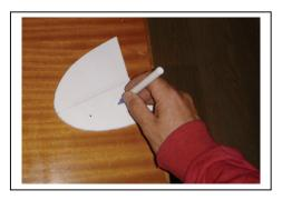
4.La position des traversées de haubans se fait à partir du gabarit papier en perçant un trou et en marquant le point avec un feutre à pointe fine
