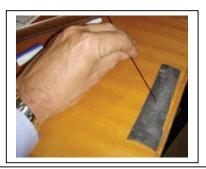
21. Réalisation des haubans en jonc carbone 10/10: Ceux-ci seront coupés aux longueurs préconisées. C'est normal qu'ils soient trop longs. La mise en longueur finale se fera après montage.
